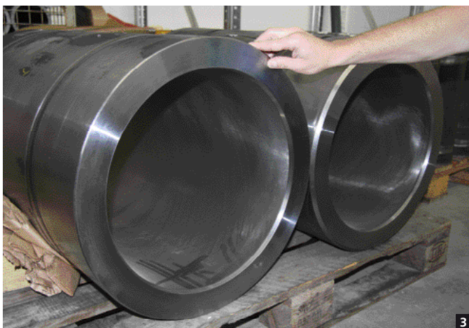
Links ein Hydraulikzylinder mit gehonter Lauffläche, rechts ein kleinerer Zylinder mit rollierter Bohrungsoberfläche.
